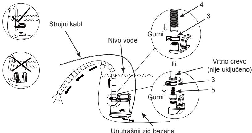
**NAPOMENA:** Maksimalna dubina bazena ne sme da bude veća od 1,22 m (48 inča). Da bi zaštitili motor pumpe od rada na suho, iskopčajte kabel za napajanje iz električne utičnice nakon ispuštanja vode ili kada je preostala voda ispod nivoa baze pumpe za pražnjenje.
